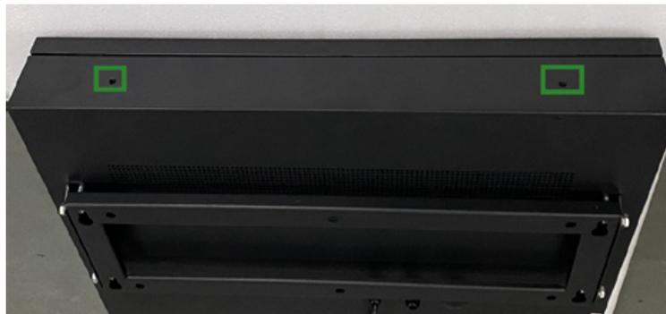
2. Il y a deux trous dans le haut du caisson pour installer des boulons à œil pour soulever l'appareil.
