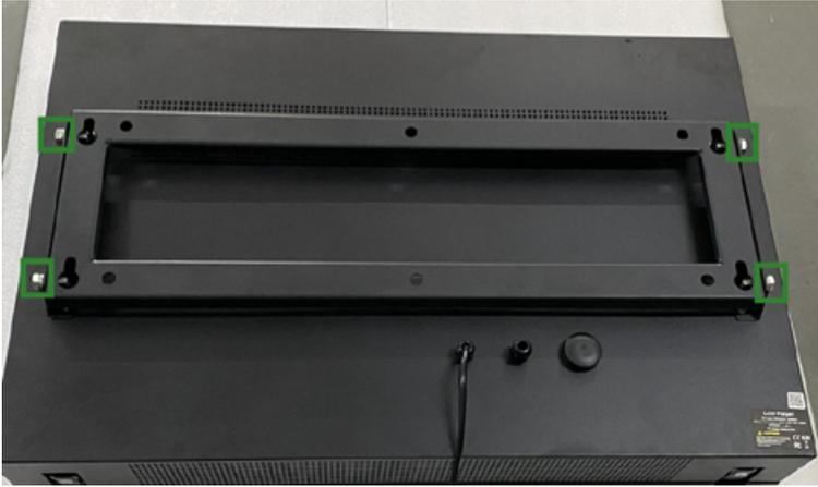
1. Retirer les vis latérales et le support mural et le fixer au mur avec des vis d'expansion.
