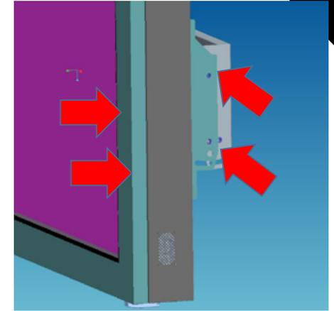
3. Maintenir l'appareil parallèle au support mural, trous des vis alignés et verrouiller les vis latérales.
